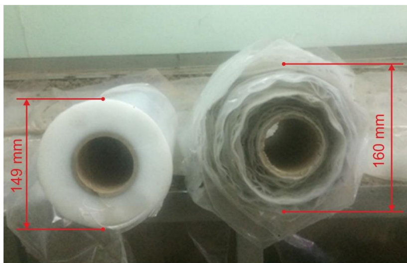
Рисунок 3.20 – Общий вид заводского рулона (слева) и перемотанного в рулон использованной пленки с поля (справа)
