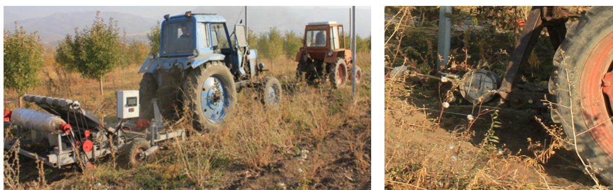
Рисунок 4.9 - Испытание тягового сопротивления агрегата
