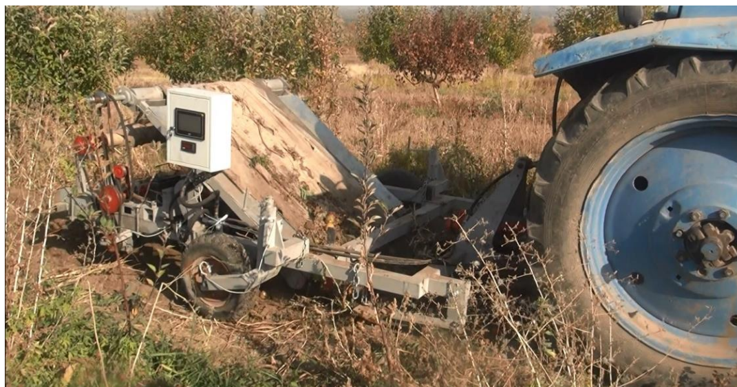
Рисунок 4.3 – Рабочий процесс удаления устройством мульчирующей пленки и гибких лент капельного орошения в послеуборочный период
