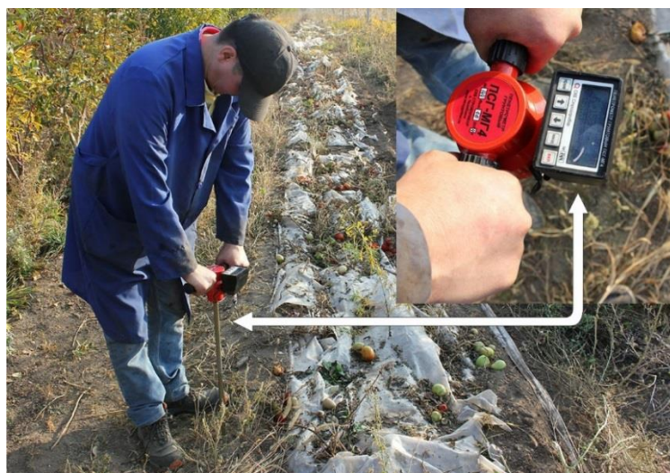
Рисунок 4.4 – Грунтовый пенетромтр в состоянии проверки почвы
