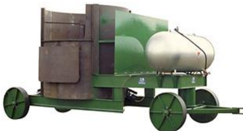
Рисунок 1.26 - Общий вид сжигателя мусора мульчи фирмы Kennco
