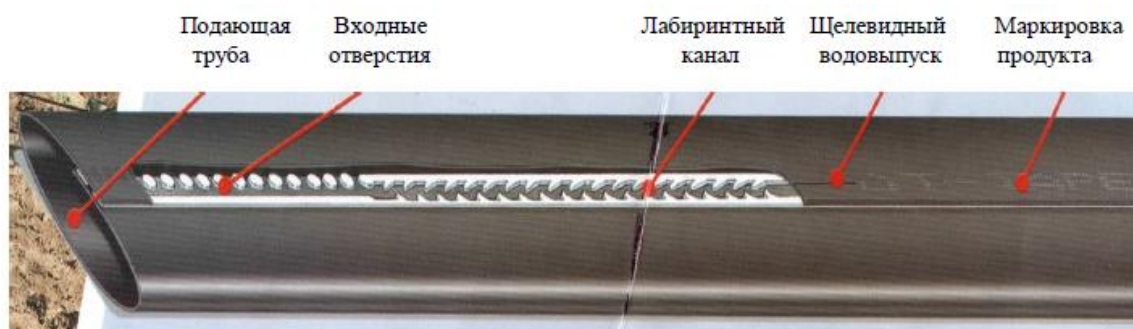
Рисунок 1.6 – Конструкция капельной ленты T-Tape
