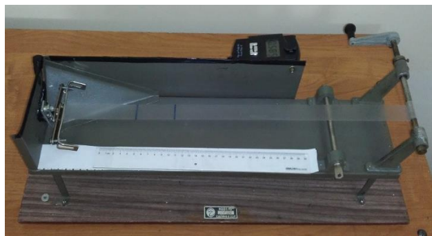
1 – рукоятка; 2 – корпус, 3 – мерная шкала, 4 – образец растяжения; 5 – тензодатчик
