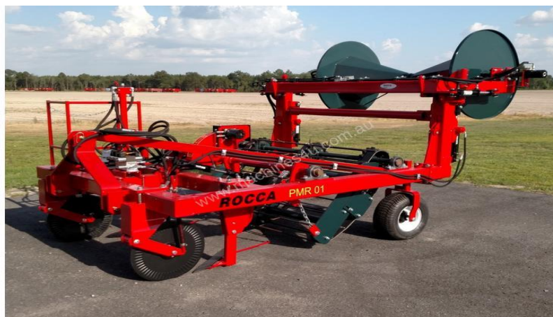
Рисунок 1.23 – Машина для удаления мульчирующей пленки PMR 01
