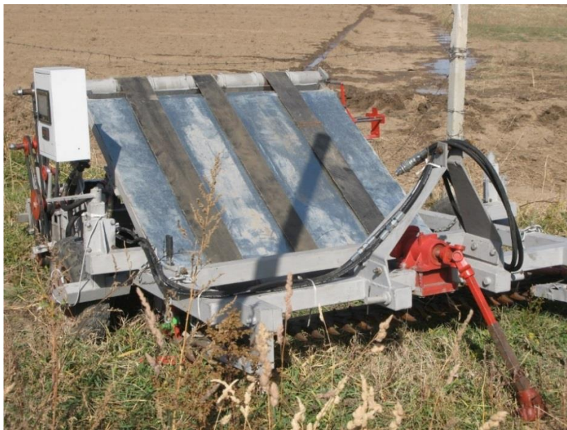
Рисунок 4.1. – Общий вид устройства для удаления мульчирующей пленки и гибких лент капельного орошения
