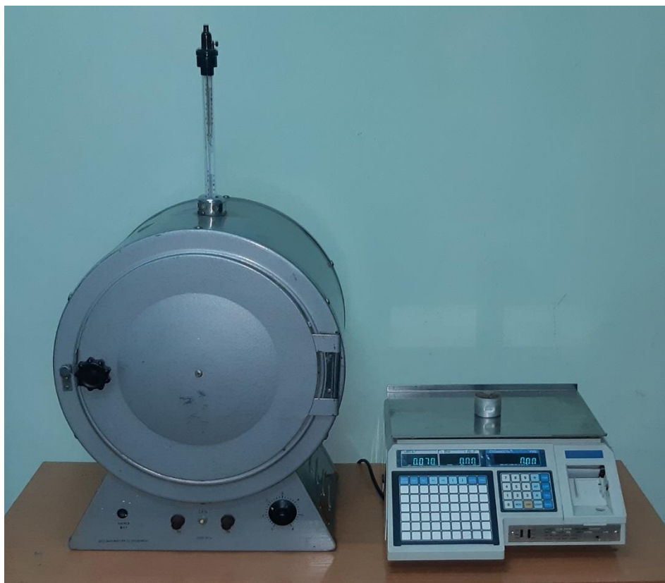
Рисунок 4.5 – Сушильный электрический шкаф и электронные весы для определения влажности почвы
