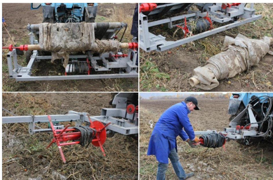
Рисунок 4.10 - Фрагменты испытания устройства для сборки мульчирующей пленки и гибких поливных лент совместно и отдельно
