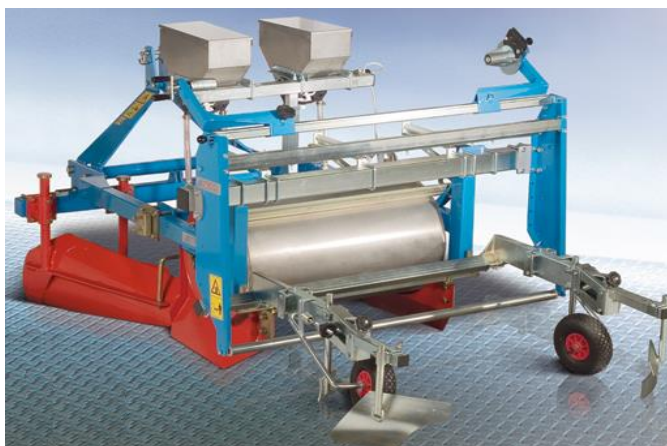
Рисунок 1.13 – Комбинированный пленкоукладчик-грядообразователь модели АР
