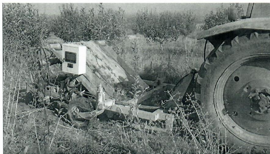
Рисунок 2 – Положение работы машины при уборке мульчирующей пленки и гибкой капельной ленты
