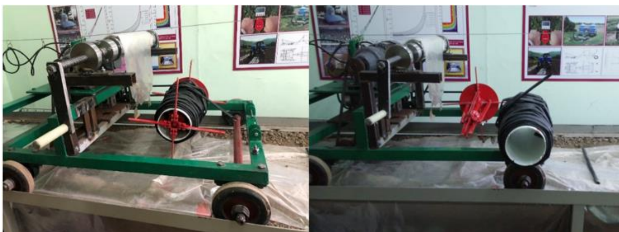
Рисунок 3.21 – Общий вид гибкой капельной ленты при намотке на лабораторном стенде (слева) и намотанной бабины (справа)
