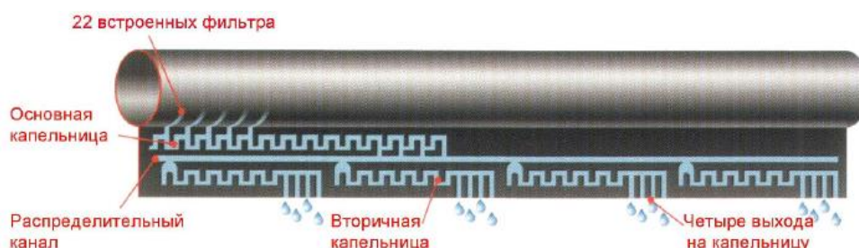
Рисунок 1.3 – Конструкция ленты капельного орошения QueenGil
