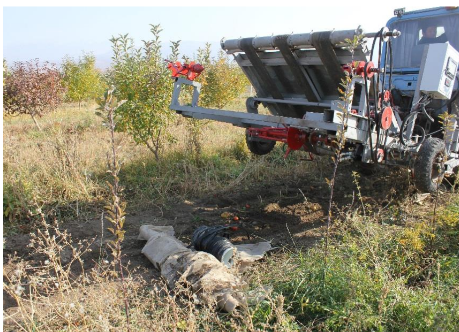
Рисунок 4.14 – Вид намотанной мульчирующей пленки и гибкой капельной ленты в момент сброса из агрегата
